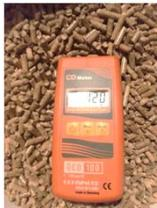
Beispiel eines mobilen Überwachungsgerätes
